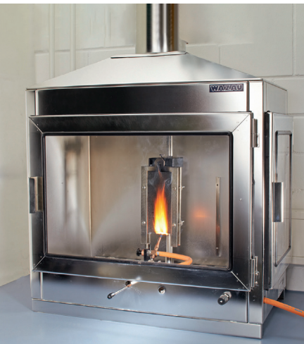
Flammschutztest an Schaumstoffen am Fraunhofer ICT
